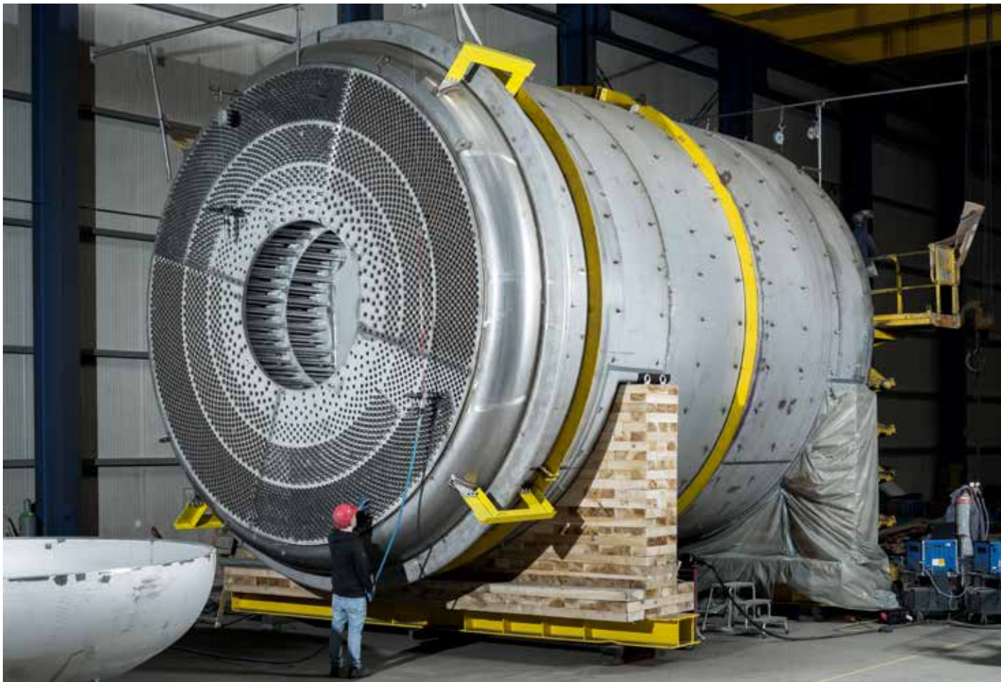
Wärmetauscher sind ein wichtiger Bestandteil von Gasreinigungsanlagen.
